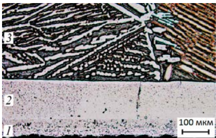
Рисунок 3 - Микроструктура поперечного сечения образца после азотирования при 2100 °С в течение 30 мин
